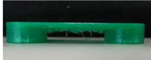
圖三：水平懸空處出現架橋問題
